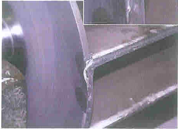
Abb. 5: Rotor nach ca. 10.000 h Einsatz, Produkt Dolomit mit SiO 2 , Steg und Seiten- scheibe Stellite auf- geschweißt und anschließend geschliffen. Die Verschleiß- rinne zeigt Entspannungs- richtung des Produkt-/Luft- gemisches
