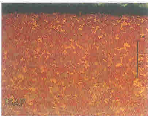
Abb. 7: Matrix mit gebrochenem Wolframcarbid
