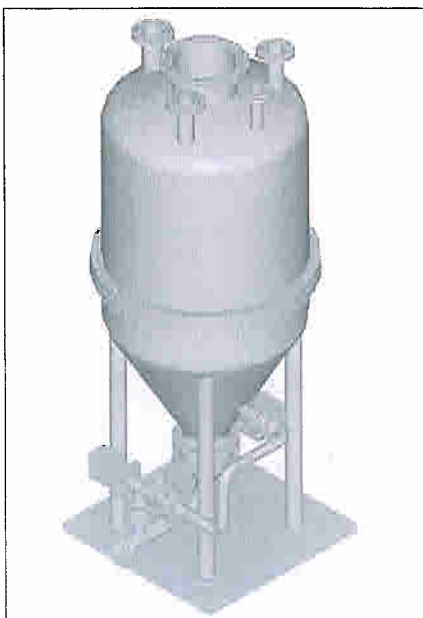
Abb. 3: isometrische Ansicht eines Druckfördergefäßes
