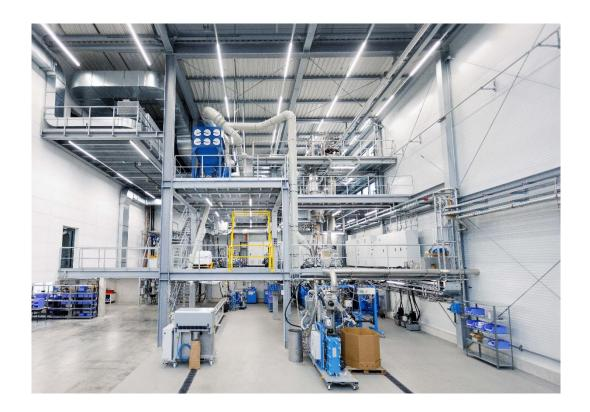
科倍隆为新的回收创新中心配备了最新的技术,可以测试从物料输送、计量喂料、挤出、配混到材料后续处理环节和除臭的每个重要的回收加工步骤。
