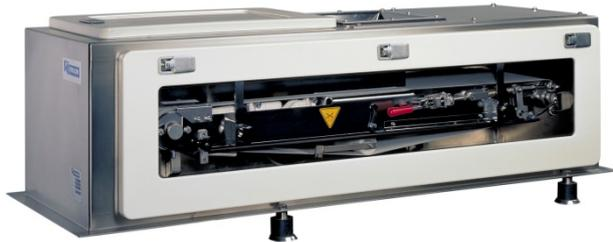
*Die neue Smart Dosierbandwaage (SWB) von Coperion K-Tron bietet kontinuierliches, automatisches Online-Tarieren mit zwei digitalen Wägemodulen Smart Force Transducer III\*. Das automatische und kontinuierliche Online-Tarieren des Bandes reduziert kostenintensive Wartung, Stillstandszeiten und arbeitsaufwendige, manuelle Kalibration und verbessert gleichzeitig die langfristige Genauigkeit.*
