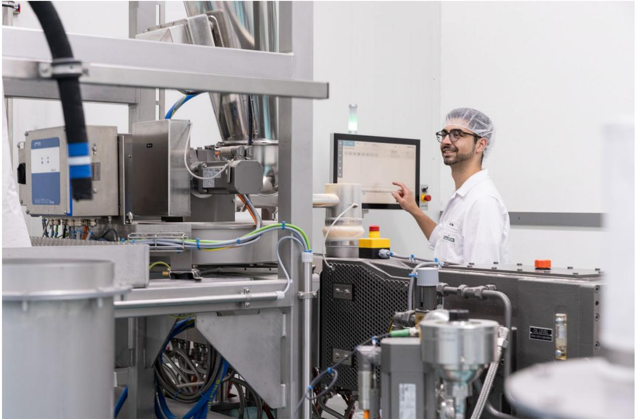
*Der ZSK 43 Mv PLUS Food Extruder bietet zusammen mit den Coperion K-Tron Dosierern große Flexibilität in der Produktion.*
