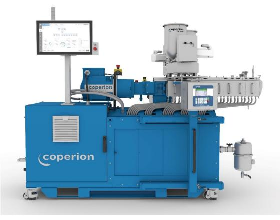
最新一代的科倍隆ZSK 18 MEGAlab实验用挤出机结合了成熟的ZSK系列功能和新的研发,专注于灵活简便的操作。
