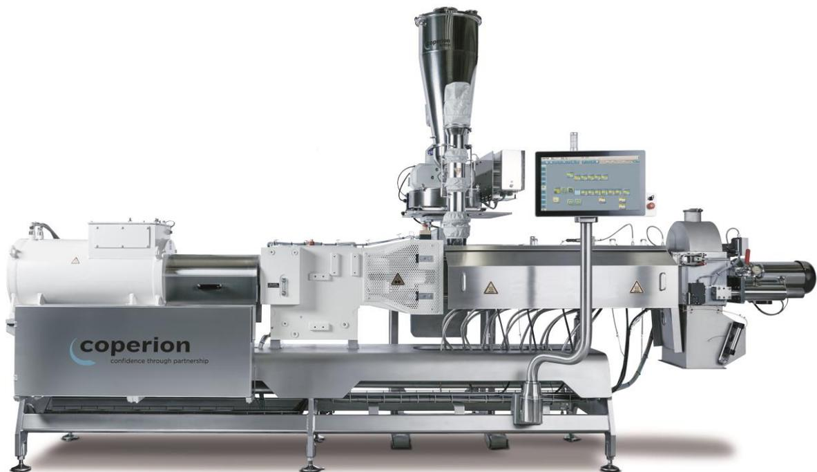
*Das Design des Doppelschneckenextruders ZSK Mv PLUS von Coperion wurde komplett überarbeitet und erfüllt in der neuen Ausführung höchste Hygiene- und Sicherheitsanforderungen.*
