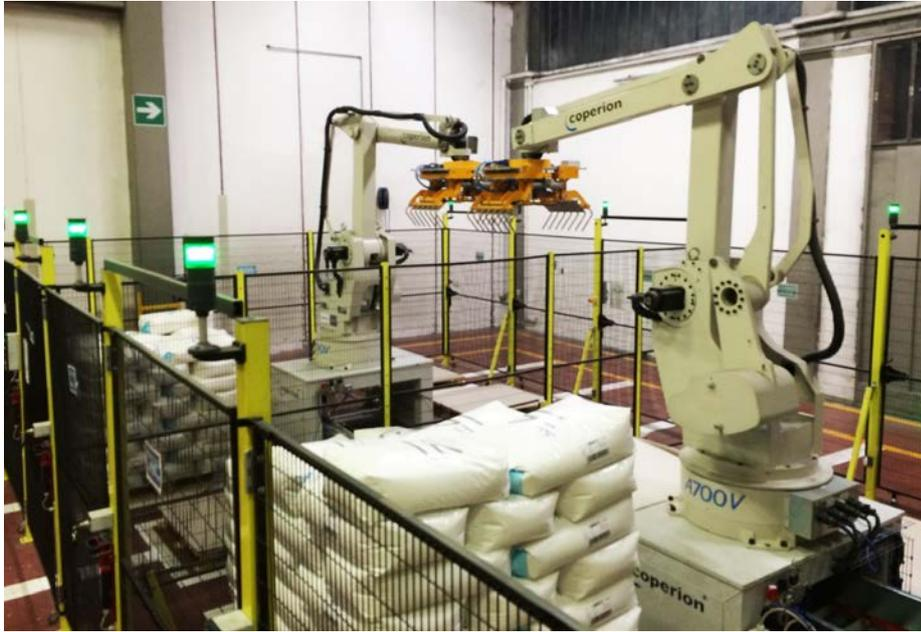
*Roboterarme für die Palettierung am Ende der Produktionslinie*
