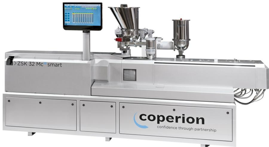
*Der ZSK Mc<sup>18</sup> smart mit einer Achsenhöhe von 800 mm für eine bequeme Zugänglichkeit und einer im Untergestell integrierten Strom- und Wasserversorgung. Die Coperion K-Tron hochgenauen Dosierer sind direkt an der Antriebseinheit montiert oder bei Bedarf an einem Schwenkarm der zweiwelligen Seitenbeschickung ZS-B.*
