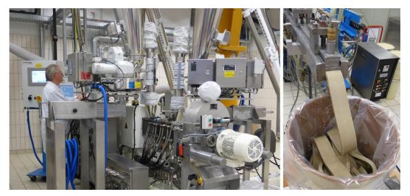
Der im Food-Technikum von Coperion installierte, mit kompletter Peripherie ausgestattete ZSK 43 MEGAvolume PLUS (Bild links) extrudierte beim Seminar direktexpandierte Cerealien. Zusätzlich wurde auf einem ZSK 26 die neuartige High Moisture Extrusion von pflanzlichen Fleischanalogen gezeigt (rechts).
