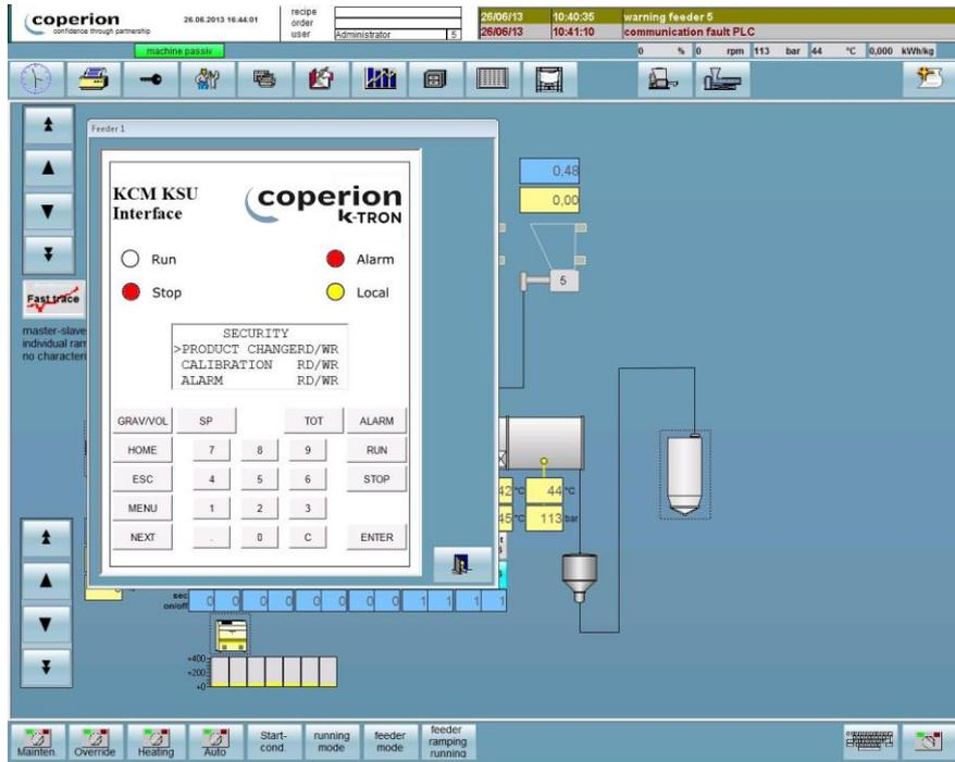
Mit der neuen Extrudersteuerung CSpro von Coperion lassen sich jetzt zentral beispielsweise angeschlossene Dosierstationen oder andere Peripheriesysteme visualisieren und steuern.
