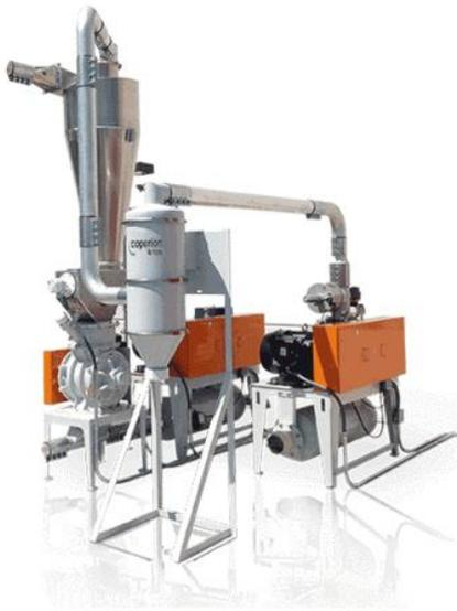
*Das Vakuumdruck-Waggon-Entladesystem mit Doppelgebläse von Coperion K-Tron transportiert Pellets, Pulver und Granulate pneumatisch aus Eisenbahnwaggons, mit Förderraten über 54.500 kg/h.*
