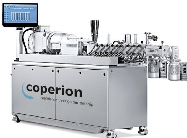
*Der vollständig überarbeitete ZSK 26 Mc<sup>18</sup> Doppelschnecken-Laborextruder mit 25 mm Schneckendurchmesser von Coperion wird in den USA erstmals vorgestellt. Er zeichnet sich durch ein erhöhtes Drehmoment von 15 Nm/cm<sup>3</sup> auf und erreicht um bis zu 100% höhere Durchsätze als bei seinem Vorgängermodell.*
