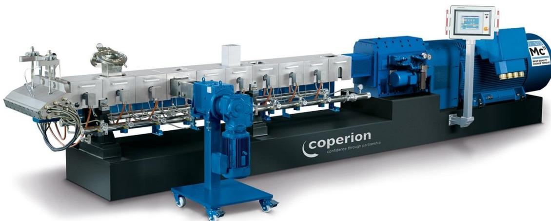
*Die neue STS Mc<sup>11</sup>-Baureihe von Coperion mit einem höheren Drehmoment von 11,3 Nm/cm<sup>3</sup> ist mit neuen Getrieben namhafter europäischer Hersteller ausgestattet.*
