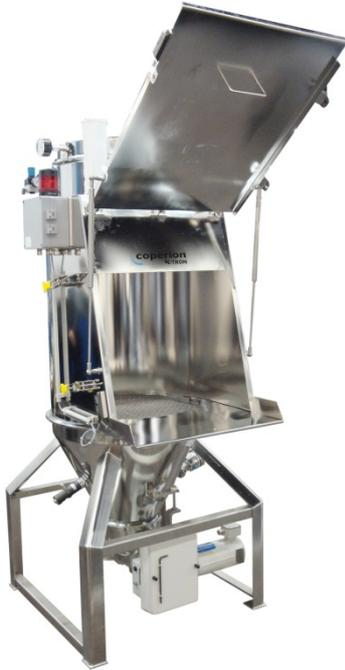
*Die Coperion K-Tron Sackentleerstation mit integrierter Staubschutzhaube eignet sich insbesondere zum staubarmen Entleeren von Schüttgütern aus Säcken. Das Gerät ist mit Filterpatronen zur Druckluftabreinigung ausgestattet.*
