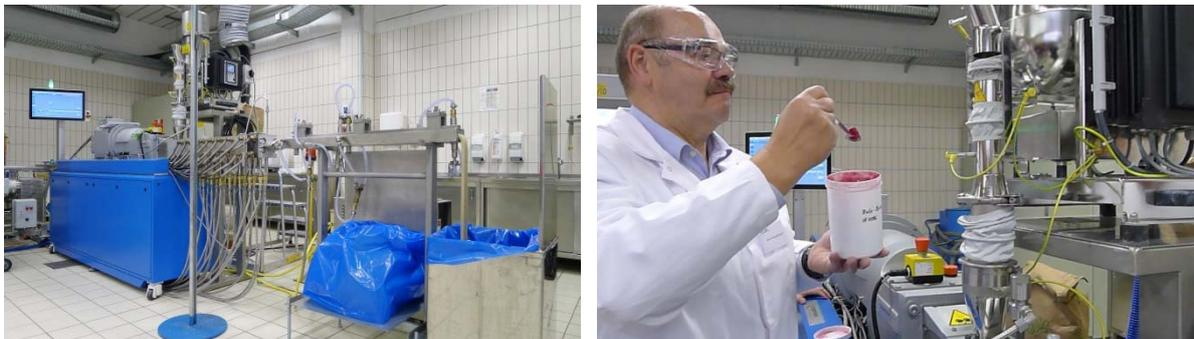
*ZSK 27 MEGAvolume PLUS mit KT 20 Dosierung (Coperion K-Tron) mit angeschlossener Kühldüse (DIL): Praktischer Teil High Moisture Extrusion Cooking von neuartigen Fleischanaloga (links). Unter anderem wurden Zusatzstoffe zur Veranschaulichung des Prozesses eingesetzt (Bild rechts).*
