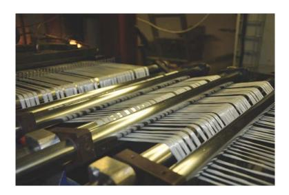
Rovingvorwärmung mit Auffächerung der Einzelfasern ermöglicht beste Einzelfaserbenetzung. Bild: ProTec Polymer Processing, Bensheim
