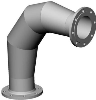
*Durch die spezielle Geometrie des GAMMA-BEND NT Umlenkbogens wird jegliches Gleiten von Granulat an der Außenwand und somit die Entstehung von Engelshaar vermieden.*
