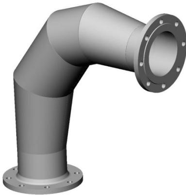
*Debido a la geometría especial de la curva deflectora GAMMA-BEND NT, se evita por completo que la granza se deslice sobre la pared exterior y, de este modo, se evita la creación de cabello de ángel.*
