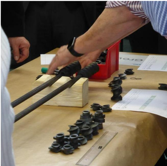
*Als Praxisübung wurden ZSK-Schneckenwellen mit verschiedenen Förder-, Misch- und Scherelementen bestückt und zu einer Schneckenkonfiguration zusammengefügt.*
