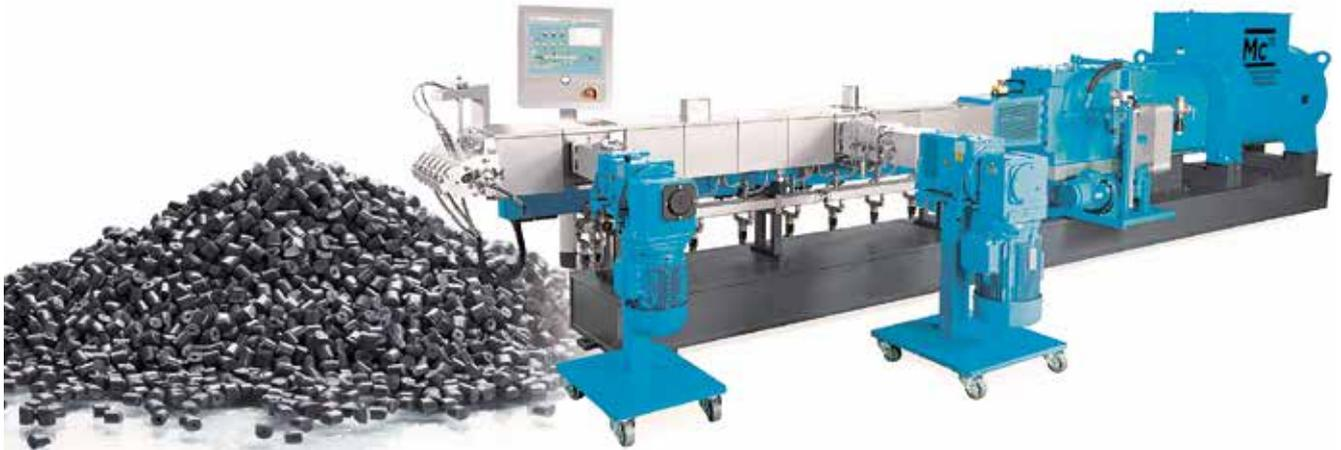
Mit einem Durchmesser Verhältnis der Schnecken von  $D_a/D_i = 1,55$  und einem spezifischen Drehmoment von  $18 \text{ Nm/cm}^3$  bietet der Doppelschneckenknetter ZSK Mc<sup>18</sup> sehr gute Prozessbedingungen für die Masterbatchherstellung (Bilder: Coperion)
