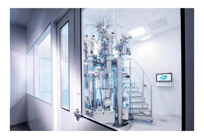
Die Coperion K-Tron Dosieranlage für das Pfizer-Werk in Freiburg integriert fünf Dosierer auf engstem Raum als Teil der kontinuierlichen Fertigung.
