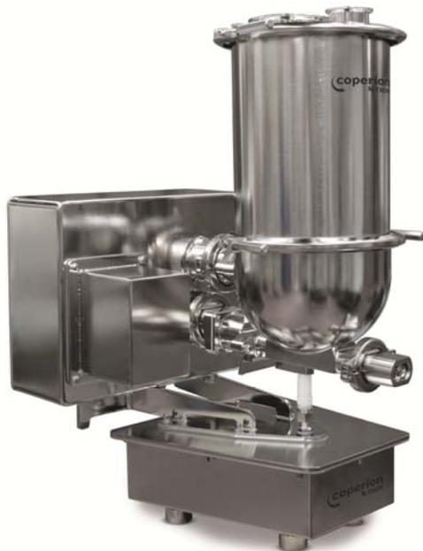
*Coperion K-Trons neuer K3-PH-QT20 Dosierer mit neugestalteter trapezförmiger Bauform der Waage ist optimal abgestimmt auf eine clustermäßige Anordnung einer Gruppe von Dosierern auf einer minimalen Standfläche.*
