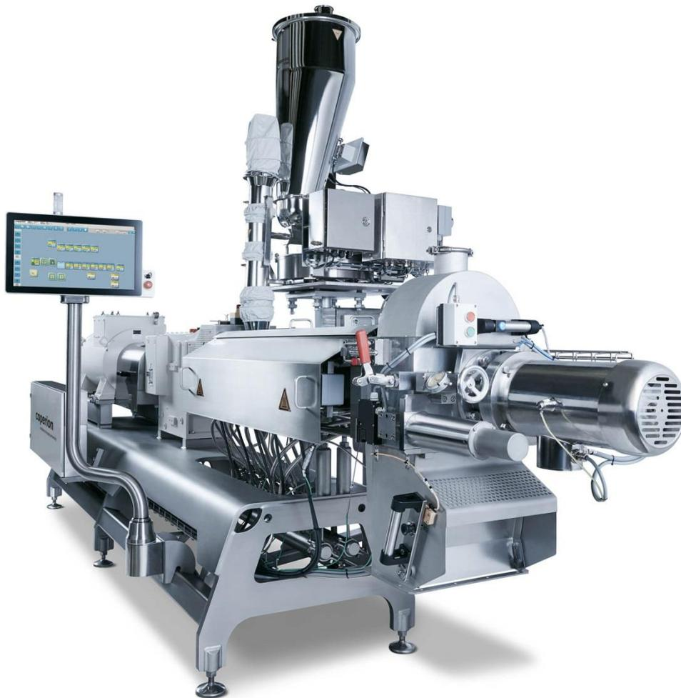
*Extrusora de doble husillo ZSK Mv PLUS, con un diámetro de husillo de 54 mm y en versión diseño higiénico, pensada específicamente para las elevadas exigencias de la producción alimentaria.*
