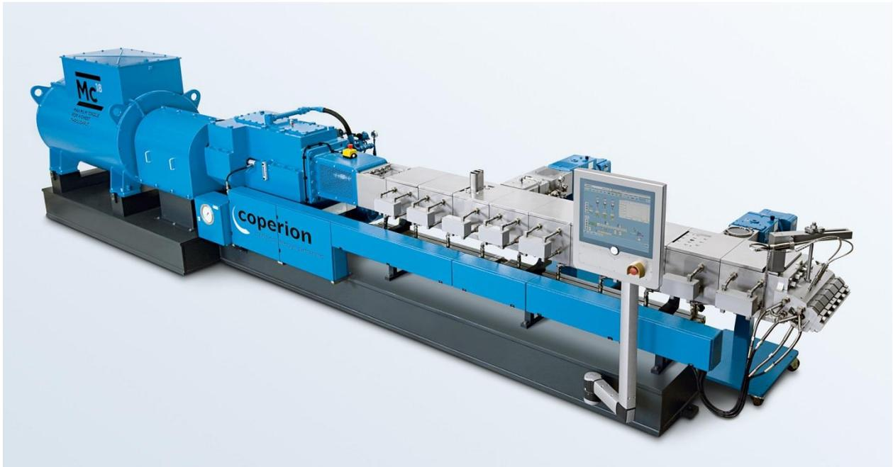
*Moderna extrusora de alto rendimiento modelo ZSK Mc<sup>18</sup>, con un par de giro específico de 18 Nm/cm<sup>3</sup> y una relación  $D_e/D_i$  de 1,55, para la preparación de productos que necesitan un elevado par de giro, p.ej. algunos polímeros técnicos.*
