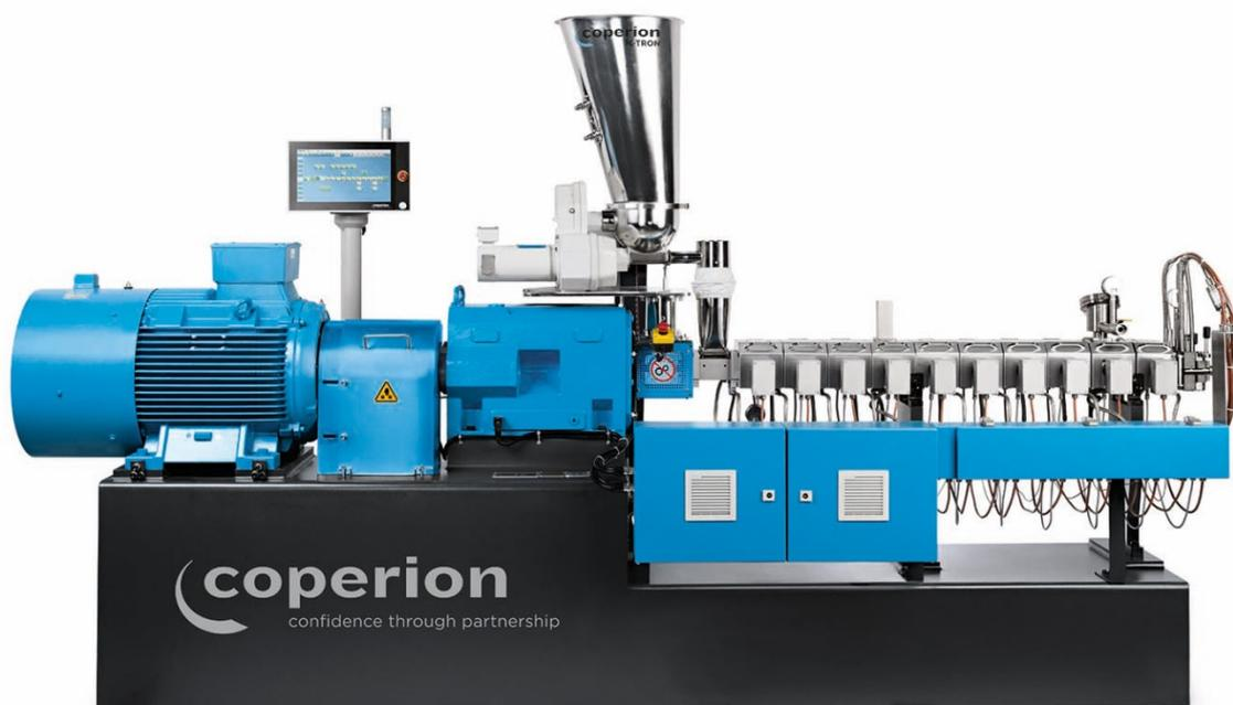
*El extrusor de doble husillo STS Mc<sup>11</sup> de Coperion tiene un par específico de 11.3 Nm/cm<sup>3</sup> y brinda hasta un 27% más de producción que el modelo anterior.*
