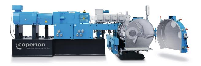
Instalación de tratamiento de dos etapas Kombiplast KP, de Coperion, equipada con el sistema de corte excéntrico EGR y el nuevo plato portacuchillas, para el que ya se ha solicitado la patente, y que permite elaborar granza de PVC con una calidad claramente superior
