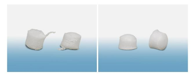
A diferencia de las cuchillas convecionales (a la izquierda), el nuevo plato portacuchillas EGR de Coperion minimiza el contenido de polvo en la granza de PVC (a la derecha).
