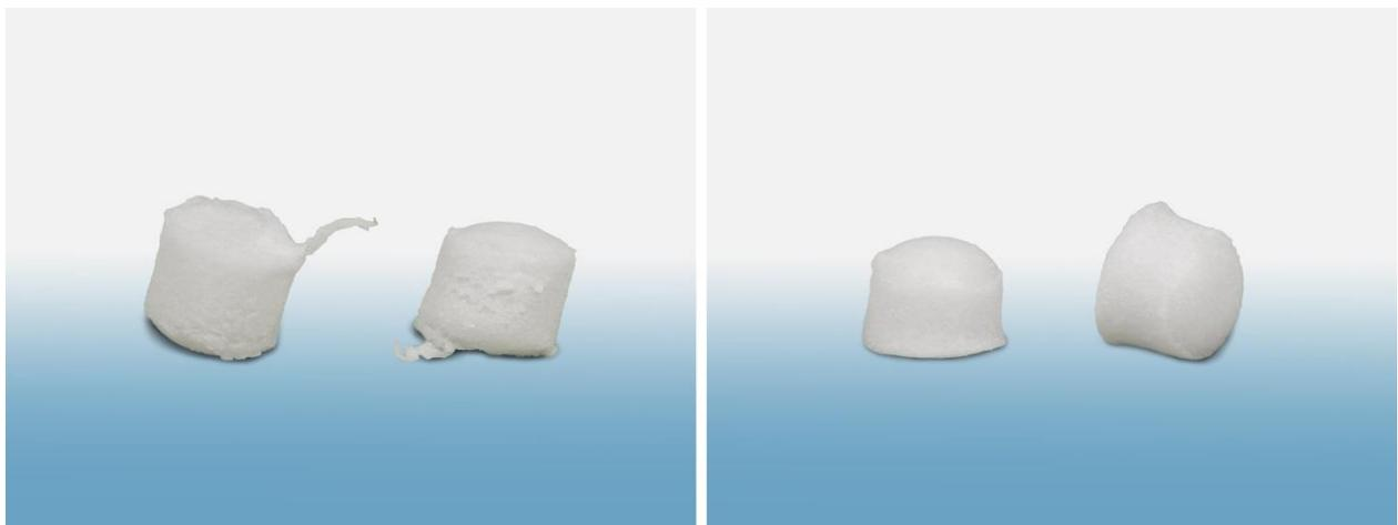
*Contrairement aux pales à couteau classiques (à gauche), la nouvelle pale à couteau EGR de Coperion réduit la teneur en particules fines dans les granulés de PVC (à droite).*
