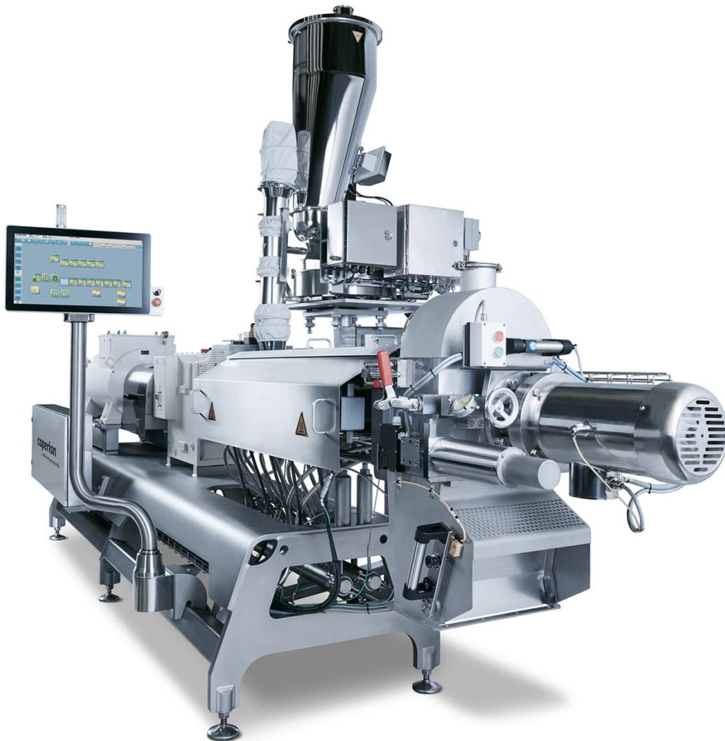
*Der Doppelschneckenextruder ZSK von Coperion ist modular aufgebaut und eignet sich für die Herstellung unterschiedlichster Batteriematerialien.*
