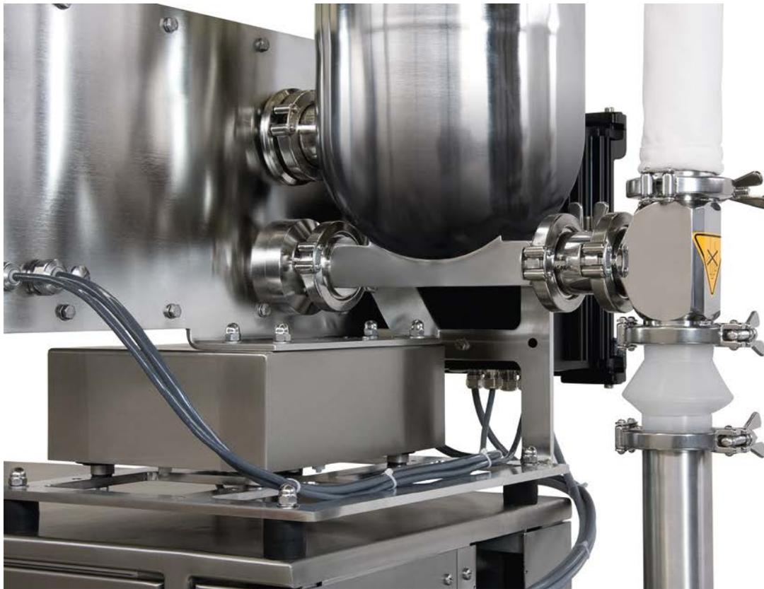
*Die Dosierungen für die Zuführung der Rohmaterialien in den ZSK-Extruder führt Coperion bei Bedarf staubdicht aus.*
