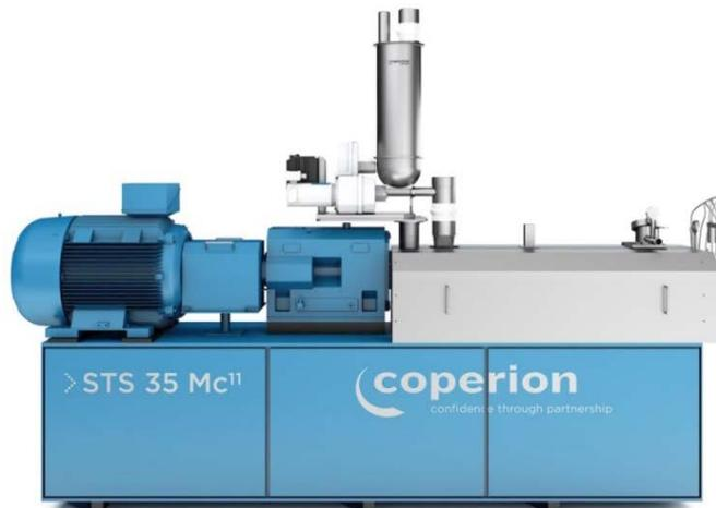
*Coperion ha equipado la extrusora de doble husillo STS Mc<sup>11</sup> para masterbatch con nuevas prestaciones, que mejoran significativamente la manipulación del sistema y la facilidad de limpieza.*
