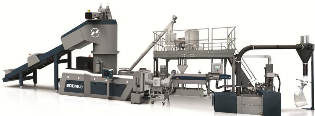
*La tecnologia COREMA® unisce i vantaggi del riciclaggio e della compoundazione in un unico impianto.*
