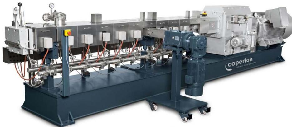
*La produzione di compound di alta qualità da materiali riciclati, l'upcycling, viene realizzata nell'estrusore bivate corotante di Coperion.*
