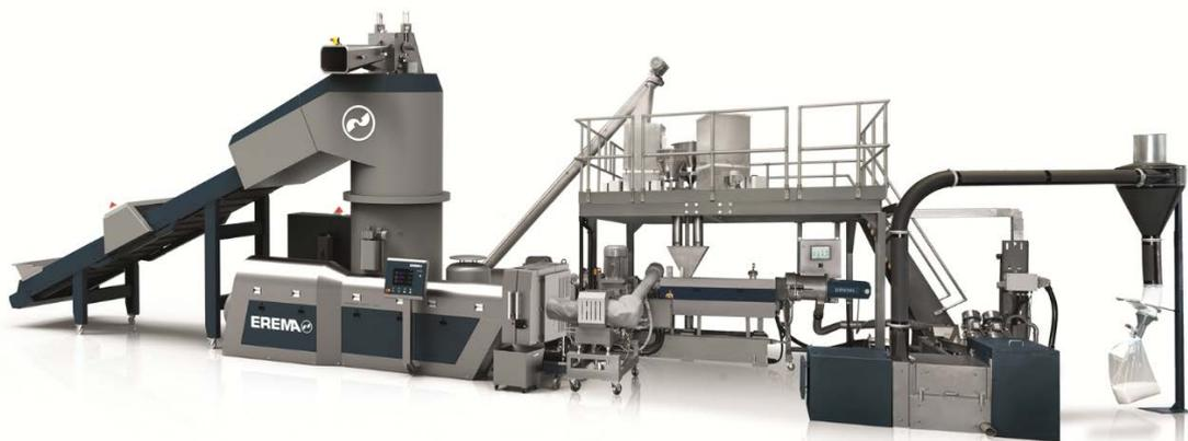
*La COREMA® allie les avantages du recyclage et du compoundage dans une seule et même installation.*
