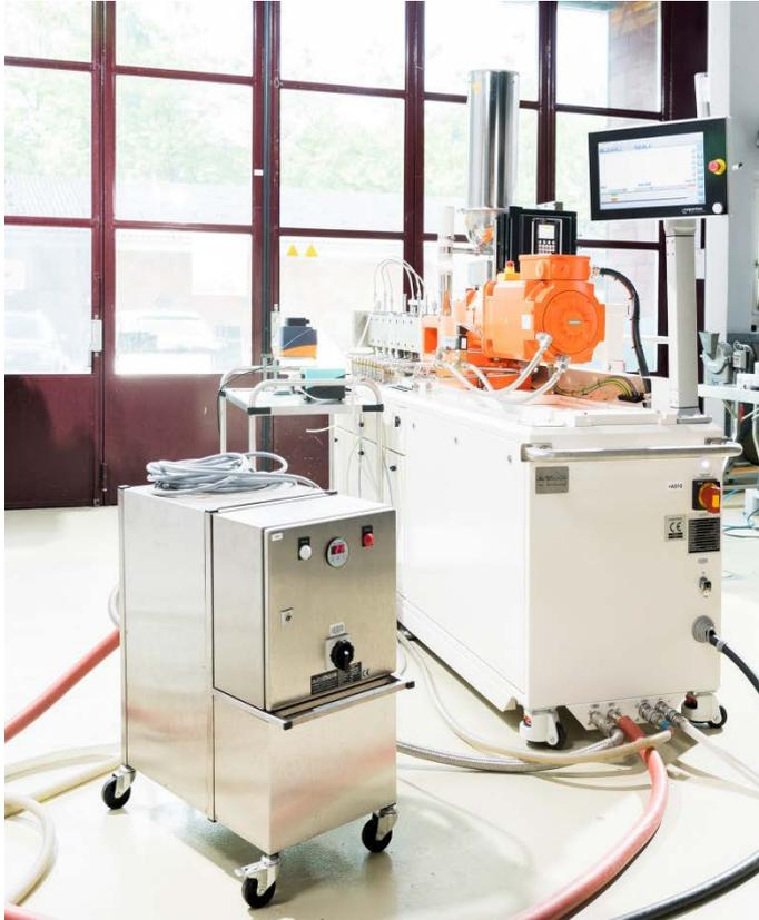
*Der Coperion Food-Extruder ZSK 27 Mv PLUS wird bei der Zürcher Hochschule für Angewandte Wissenschaften für unterschiedlichste Forschungs- und Entwicklungsarbeiten eingesetzt und verfügt daher über zahlreichen Schnellwechsel-Features und Vorrichtungen für den flexiblen Verfahrensaufbau.*
