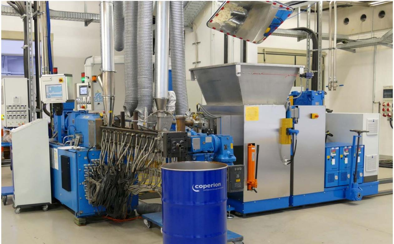
*Laboraufbau für die Produktion eines HMPSA (Hot Melt Pressure Sensitive Adhesive) mit einem ZSK 34 Mv PLUS Doppelschneckenextruder von Coperion und einem Roll-ex-System zur Mastifizierung der als Rezepturbestandteil bereitstehenden Kautschukballen.*
