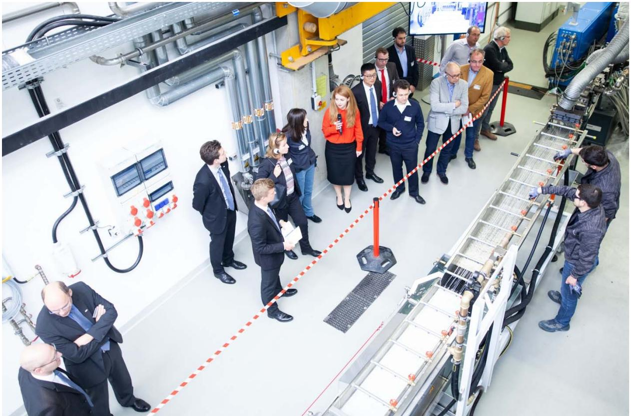
*Laboraufbau für die Herstellung eines Antiblock-Masterbatches auf einem ZSK 58 Mc<sup>18</sup> Doppelschneckenextruder, der mit der patentierter Feed Enhancement Technologie (FET) und der neuen halbautomatischen Strangzuführung SCP von Coperion ausgerüstet ist.*
