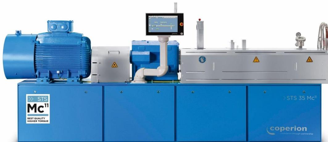
La extrusora de doble husillo STS 35 Mc<sup>11</sup> de Coperion está equipada con numerosas prestaciones que aseguran la producción rentable de masterbatches.
