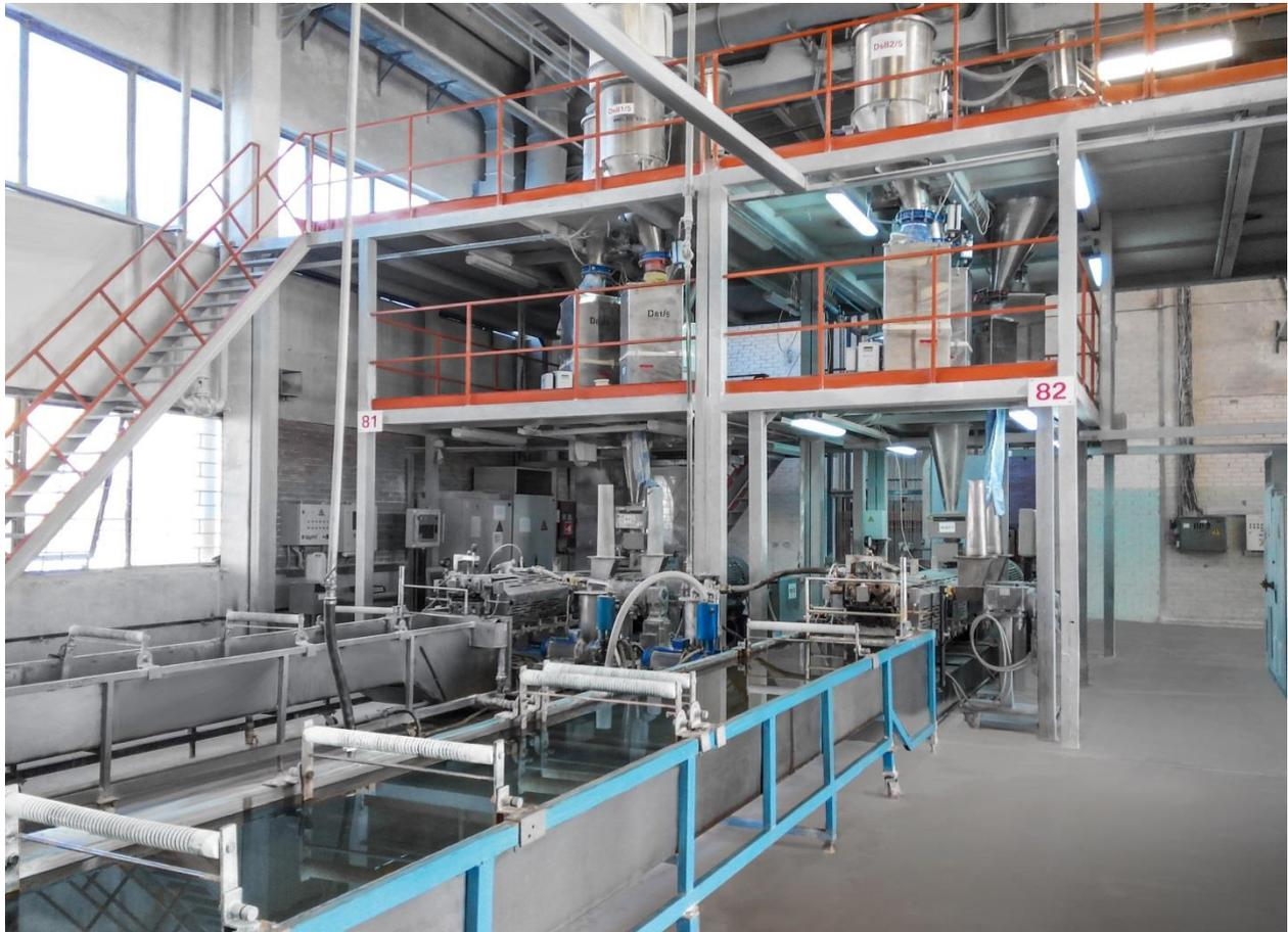
Auf Doppelschneckenextrudern des Typs STS 75 von Coperion produziert R&P POLYPLASTIC hauptsächlich Polypropylen-, Polyamid- und Polyethylen-Compounds für die Automobilindustrie, für Haushaltsgeräte und Baustoffe.
