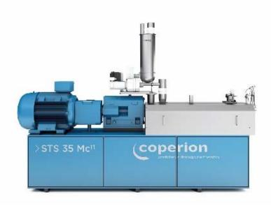
Coperion ha equipado la extrusora de doble husillo STS Mc<sup>11</sup> para masterbatch con nuevas características que mejoran significativamente el manejo del sistema y la facilidad de limpieza.
