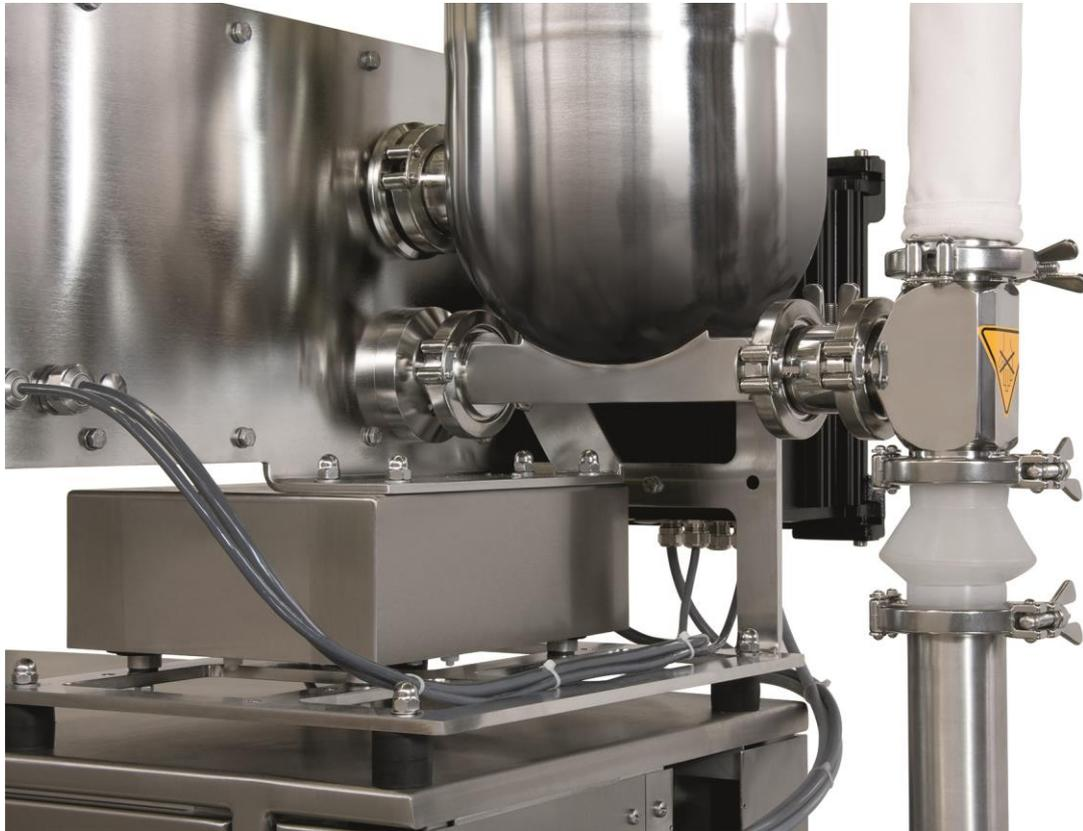
*Bei Bedarf werden die Coperion K-Tron Dosierer für die Zuführung der Rohmaterialien in den ZSK-Extruder staubdicht ausgeführt.*
