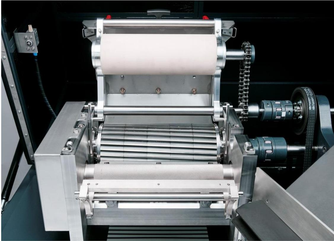
SP 240拉条切粒机配有新的切粒间隙调整技术，可以更加快速和舒适的调整。
