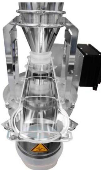
*Präzise, parallele Bewegungen gewähren einen gleichmässigen Materialfluss über die gesamte Länge der Rinne des Coperion K-Tron K3 Vibrationsdosierers.*
