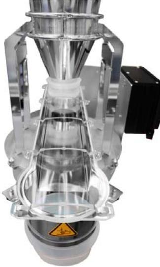
精确且平行的运动确保了产品可沿新型 Coperion K-Tron K3 振动喂料盘整个长度实现均匀物料流动。
