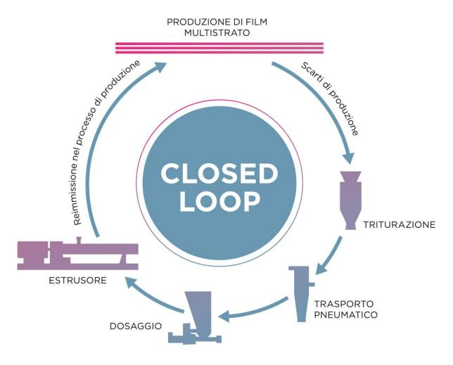
Con l'innovativo approccio closed loop di Coperion, gli scarti che si determinano durante la produzione dei film multistrato vengono reimmessi al 100 percento nel processo di produzione e riciclati.
