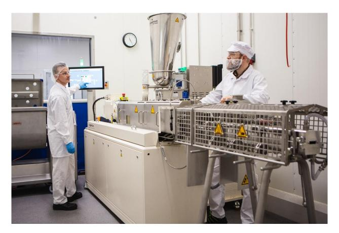
Der Coperion ZSK Food-Extruder in Hybrid-Design und das dazu gehörige Peripherie-Equipment geben Foodwest eine sehr hohe Flexibilität bei den umfangreichen Produktversuchen mit Fleischersatz und weiteren Forschungs- und Entwicklungsarbeiten für Kunden.
