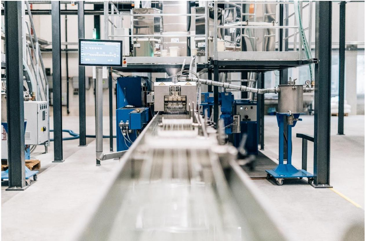
Die Compoundieranlage rund um den Coperion-Extruder ZSK 45 Mc<sup>18</sup> hat kürzlich ihren Betrieb aufgenommen und dient HEROPLAS für die Herstellung von Polyolefinen für Spezialanwendungen in Klein- bis Kleinstmengen.
