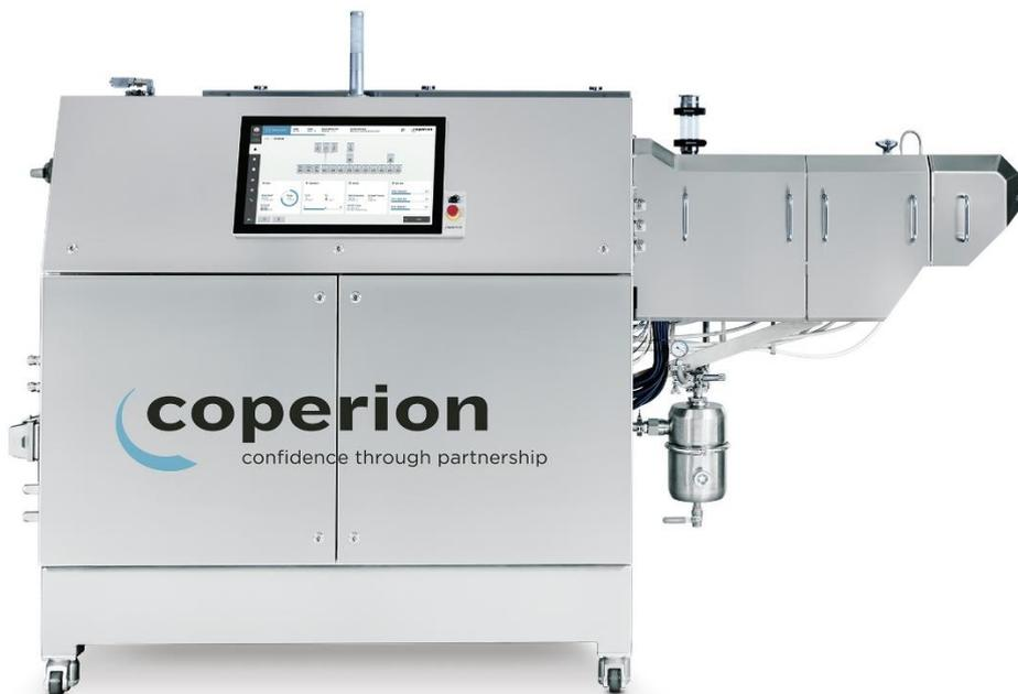
*ZSK 18 MEGA lab Doppelschneckenextruder wird bei der Technischen Universität Braunschweig eingesetzt, um eine Modernisierung und neue Industrie 4.0-Ansätze bei der Herstellung von Batteriematerialien zu erforschen.*
