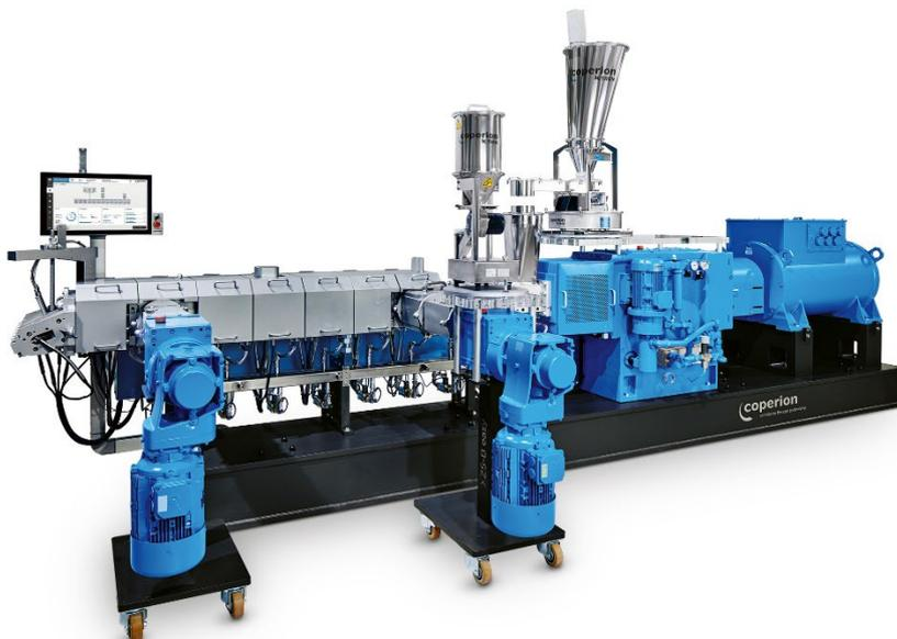
*Im Projekt wird im Coperion ZSK Doppelschneckenextruder die Einarbeitung der Füllstoffe ins Polymer verbessert, um die Bildung von Agglomeraten und die mechanische Degradation des Polymers während des Compoundierens zu vermeiden.*
