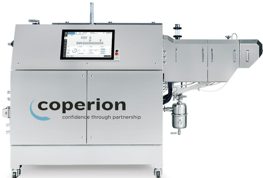
*Die kontinuierliche Extrusion von Batteriemassen mit dem ZSK-Doppelschneckenextruder bietet zahlreiche Vorteile und ermöglicht eine Effizienzsteigerung in der Produktion.*
