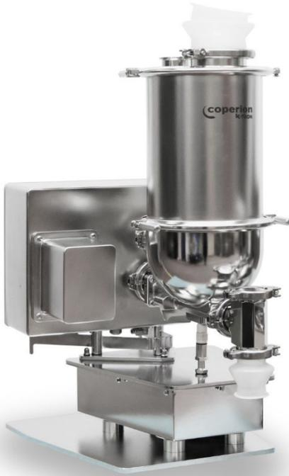
*Die Coperion K-Tron K3 Dosierer eignen sich ideal für die genaue und staubdichte Zuführung der Rohmaterialien in den Prozess.*
