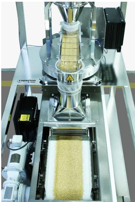
*Die neuen Coperion K-Tron K3 Vibrationsdosierer bieten eine schonende Dosierung, höhere Genauigkeit und schnelle Produktwechsel.*
