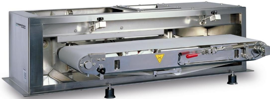
La báscula dosificadora de cinta SWB-300 de Coperion K-Tron es un dosificador gravimétrico extremadamente fiable que ofrece una gran precisión y un control eficaz del proceso.
