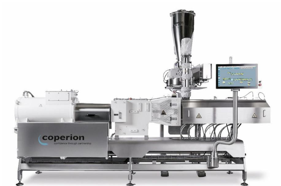
*L'estrusione continua di composti per batterie con l'estrusore bivate ZSK offre numerosi vantaggi, tra cui la qualità costantemente elevata dei composti per batterie.*
