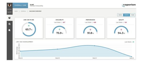
C-Beyond ist die sichere digitale Plattform von Coperion, die die Kunststoffindustrie unterstützt, die Maschinen- und Anlagenproduktivität zu maximieren. Im OEE-Dashboard werden die Maschinendaten in aggregierter Form angezeigt und bieten zahlreiche Möglichkeiten für eine wertvolle Analyse
