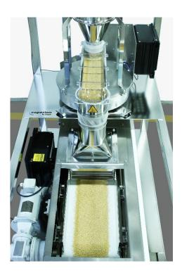
Die neueste Generation der Differentialdosierer mit Vibrationsrinne von Coperion K-Tron ermöglicht eine schonende Behandlung des Schüttguts, eine höhere Genauigkeit und kürzere Umrüstzeiten.
